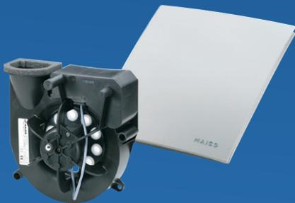
CENTRO-H: Das Abluftelement mit automatischer Feuchtesteuerung regelt die Grund- und Bedarfslüftung. Grundlüftung von ca. 30 m<sup>3</sup>/h, Bedarfslüftung max. 65 m<sup>3</sup>/h. Bei einem schnellen Feuchteanstieg um 7 % schaltet das Abluftelement in den Vollastbetrieb (Bedarfslüftung). Sinkt die relative Feuchte unter den Referenzwert ab, schaltet das Abluftelement selbsttätig auf Grundlastbetrieb oder auf Aus zurück.
