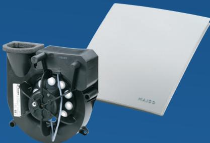
CENTRO-E: Durch das Abluftelement wird permanent eine Grundlüftung sicher gestellt. Bei Bedarf kann z.B. über einen Lichtschalter die Abluftöffnung über den elektromechanischen Stellantrieb erweitert und so ein höherer Volumenstrom erzielt werden. In der Bedarfslüftung werden max. 65 m<sup>3</sup>/h erreicht.
