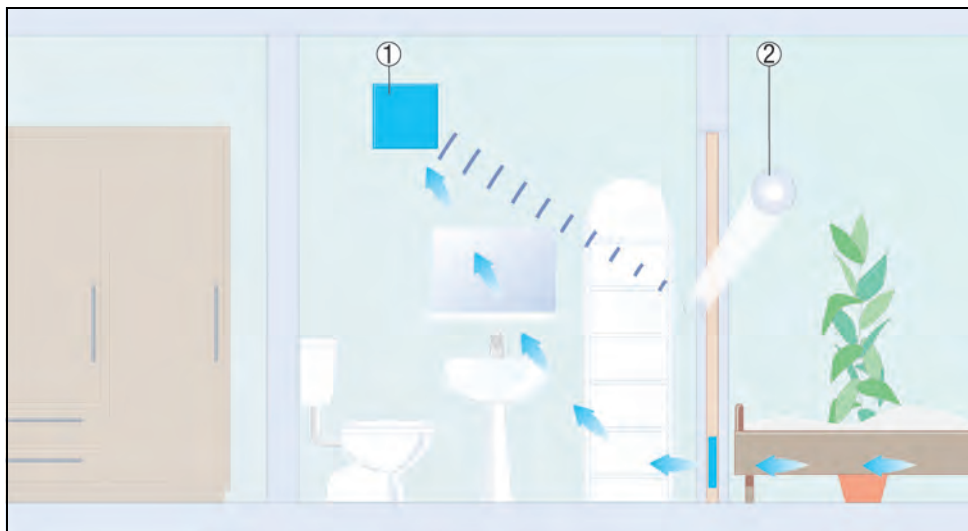
Prinzipbild MAICOsmart - installiert ist ein Ventilator und ein Funkschalter
